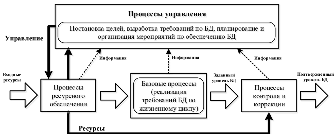
Рис. 3. Схема взаимосвязи процессов обеспечения безопасности движения
