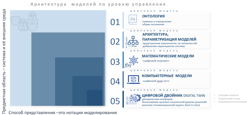
Рис. 5. Унифицированный алгоритм создания «цифрового двойника»
